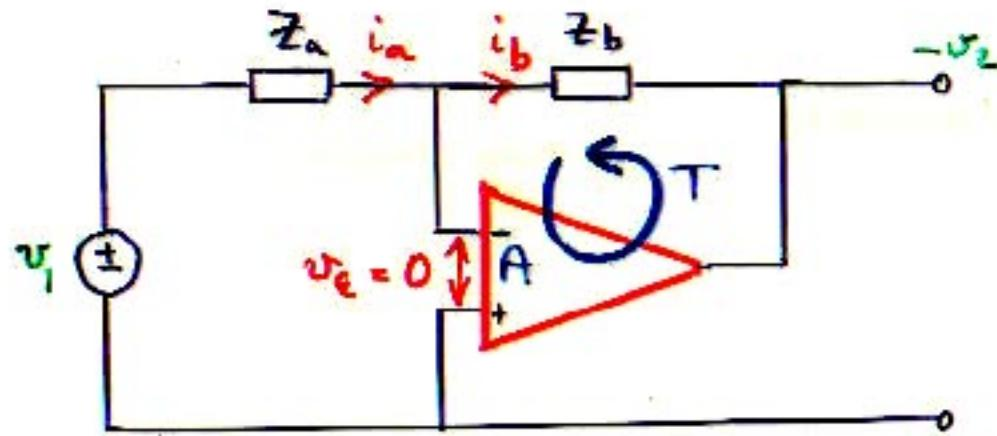
For zero error signal  $v_e = 0$ :  $i_b = i_a$
